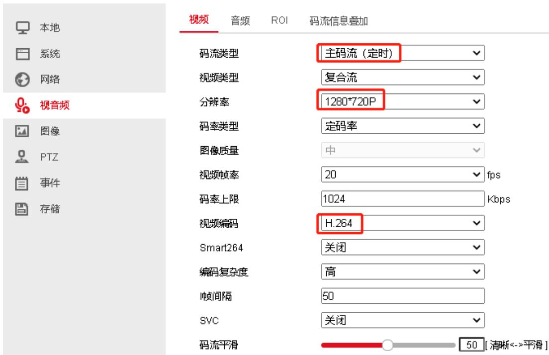
注：有些视频话机只支持 H264, Base Profile, VGA 分辨率。此时，需要调整摄像头的配置。Base Profile 对应海康摄像头的编码复杂度：低
